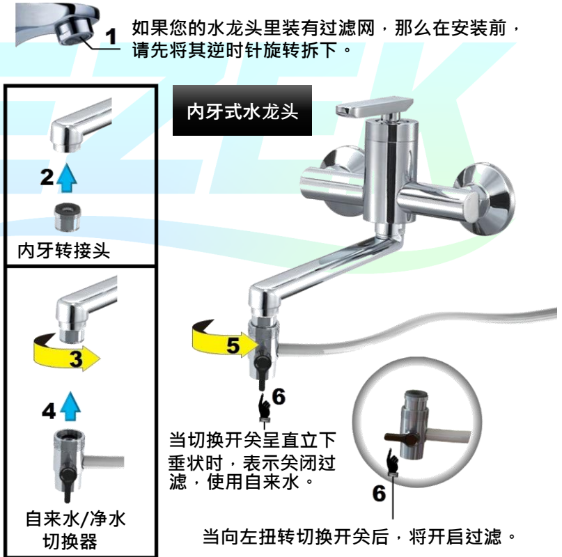
图 3 内牙式水龙头安装示意
