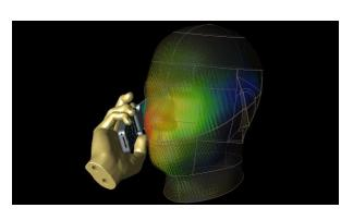
手机、平板、智慧型穿戴式装置,医疗设备等产品由于会和人体密切接触,需要确保安全无虞,因而会需要计算 SAR来了解电磁辐射对人体的影响,XFdtd支持不同标准的 SAR 计算,用户可以配合标准的 CTIA 头/手模型或是使用软件自带的高分辨率人体网格模型进行各种仿真。
