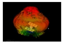
将螺旋天线导入 XGTD, 配置在人造卫星上进行 仿真,求得受到载具影响的实际天线场型。
