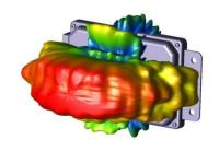
XFdtd 也经常用于各种雷达设计,如透地雷达,车用雷达或各种不同用途的雷达,左图为一个除天线以外,亦包含外壳以及 PCB 等所有零件完整的汽车雷达模型,汽车雷达经常在较高的工作频率使用,FDTD 算法可以在模型的精度和硬件资源消耗之间取得平衡。
