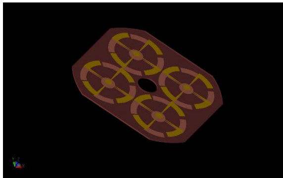
圖二：位于結構中間的偶極子陣列，四個偶極子單元分別被列印在基板上下兩面。
