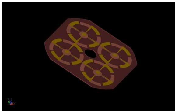
图二：位于结构中间的偶极子阵列，四个偶极子单元分别被列印在基板上下两面。
