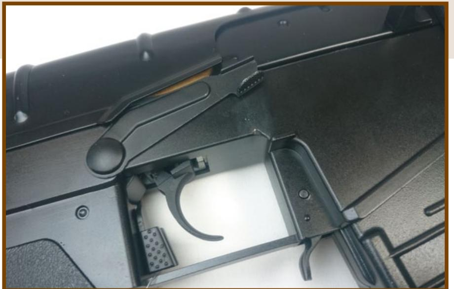
AS Val 的保險在扳機的右上方，操作方式與 AK 相同。
