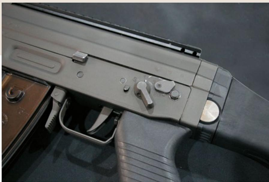
鋼製三發點放火控系統及槍機後定鈕。
