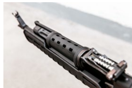
Zhukov護木上的瓦斯鋼管保護蓋，在實銃功能上是防止誤觸燙傷。
