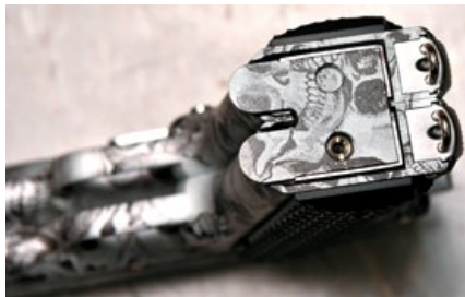
彈匣底部只有一個進氣口，以確保氣壓相同。
