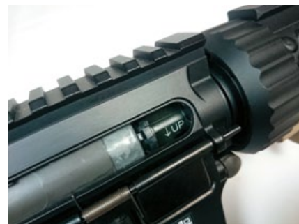
可動式槍機片內的上旋組(Hop-up)調整鈕。
