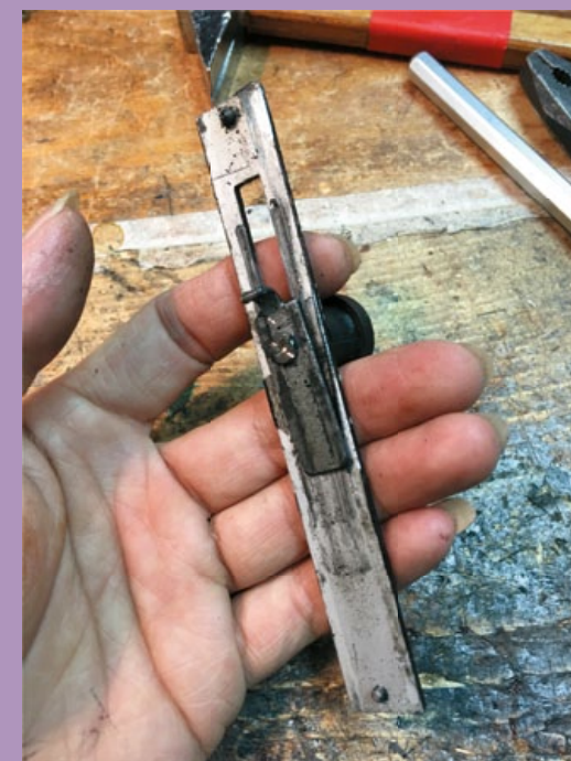
用不鏽鋼螺絲製作槍機拉柄與槍機拉柄聯結。
