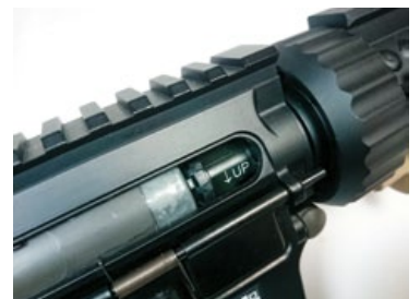
可動式槍機片內的上旋組(Hop-up)調整鈕。
