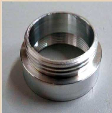
PPS堅哥為加裝LS110A雷指器而製作的鋁質連接器。
