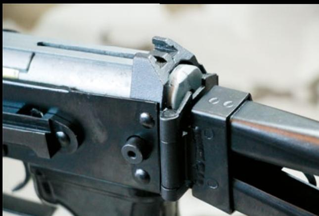
已加強穩固的鋼製復進簧後牆板。
