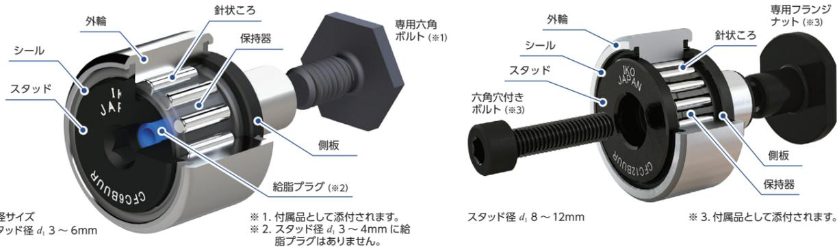
短軸カムフォロアCFC・・・Bに新たなラインナップが加わりました。スタッド径3mmまでの小サイズに対応しており非常に軽量・コンパクトです。カムフォロアとして標準品<sup>\*4</sup>と同等の性能を維持しているため、標準品からの切替えにあたり装置の強度や寿命の再検討は必要ありません。また一部のサイズでは、お客様による再給脂も可能ですので、適切なメンテナンスによって長期間の使用にも耐えられます。CFC・・・Bは、従来のカムフォロアと比較して取付けスペースの大幅な削減が実現できるため、設計自由度が広がり、幅広い分野で生産効率の向上に大きく貢献します。
