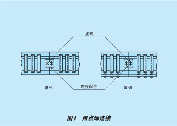
图1 用点焊连接
