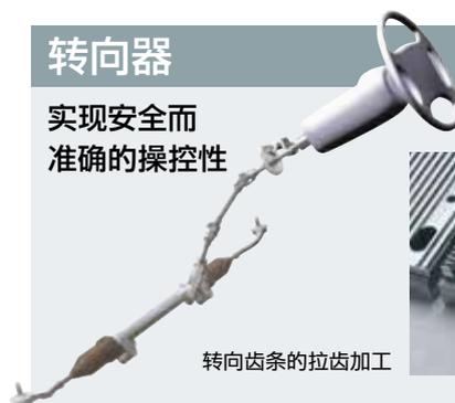
转向齿条的拉齿加工
